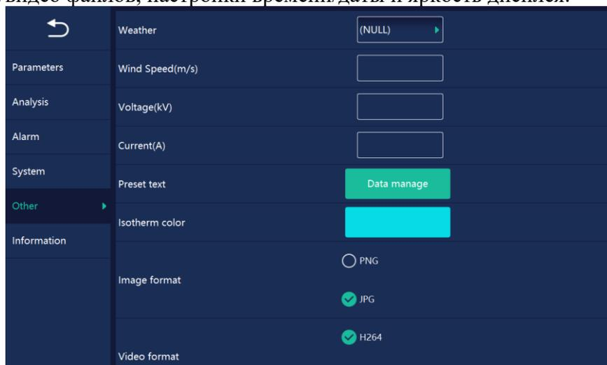
Дополнительно можно настроить параметры «Погода», «Скорость ветра», «Напряжение» и «Ток нагрузки» в соответствии с текущими условиями или оставить эти поля незаполненными;
